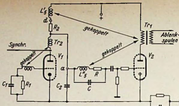
Bild 107. Vertikal-Ablenkschaltung nach Telefunken
