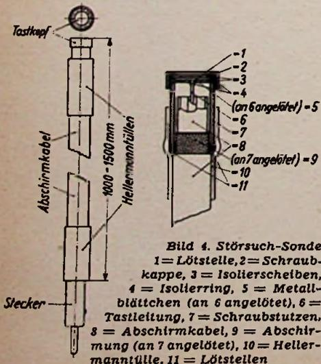
Bild 4. Störsuch-Sonde
