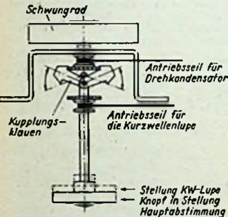
Bild 1. Kupplungsvorrichtung für die Umschaltung von der Hauptabstimmung auf die Kurzwellenlupe
