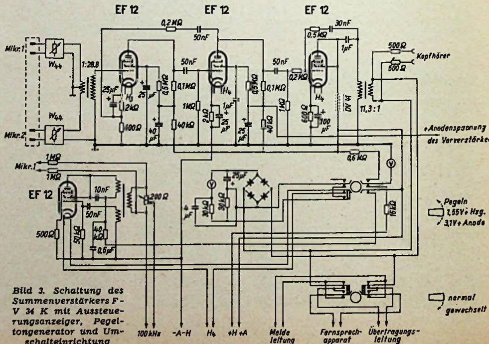
Bild 3. Schaltung des Summenverstärkers F - V 34 K mit Aussteuerungsanzeiger, Pegeltongenerator und Umschalteinrichtung
