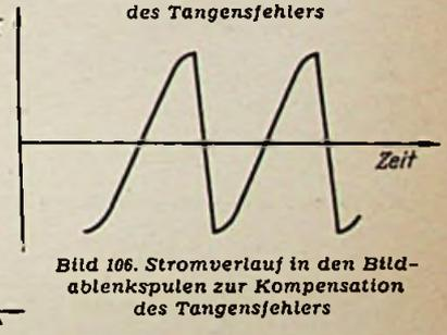
Bild 106. Stromverlauf in den Bildablenkspulen zur Kompensation des Tangensfehlers
