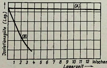
Bild 2. Isolationsgüte von Kondensatoren bei Lagerung im Feuchtraum nach Bild 1. A = neuzeitlicher Tauchkondensator (Wima-Tropydur), B = Kondensator der Klasse 3 in Preßstoff- oder Hartpapierrohr, der durch Feuchtigkeit gelitten hat. (Nach Messungen der Fa. Wilhelm Westermann, Unna/Westf.)
