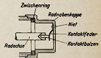
zeichnete Radnaben-Entstörätze auf Lager und liefern dazu auch die entsprechende Einbau-Anleitung. Ebenso sind diese auch bei den Autoempfänger herstellenden Fabriken erhältlich (Bild 10).
