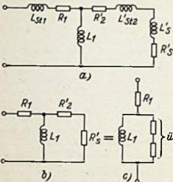
Bild 102. Ersatzschaltungen des Vertikalübertragers
