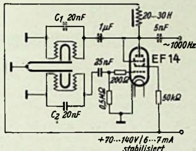
Bild 1. Schaltung des Stimmgabelgenerators. Eingetragene Werte für eine 1000-Hz-Stimmgabel. Bei Verwendung von Stimmgabeln niedrigerer Frequenz müssen  $C_1$  und  $C_2$  entsprechend größer werden
