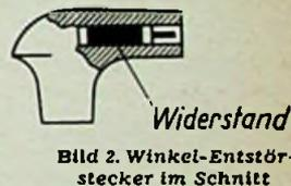
Bild 2. Winkel-Entstörstecker im Schnitt
