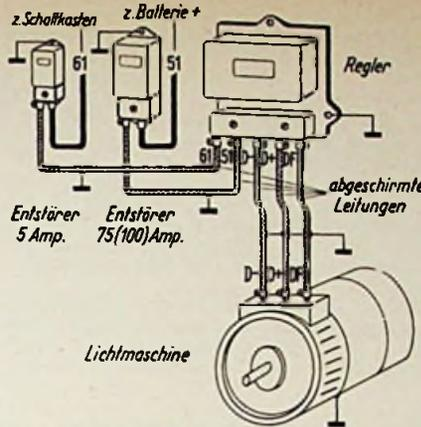
Bild 8. Entstörung von Lichtmaschinen mit getrenntem Regler für Verbraucher über 300 Watt
