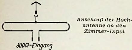
schon eine gute Hochantenne für den normalen Rundfunkbereich zur Verfügung hat, kann diese in vielen Fällen zur Verbesserung seines UKW-Empfangs in folgender Weise heranziehen.
