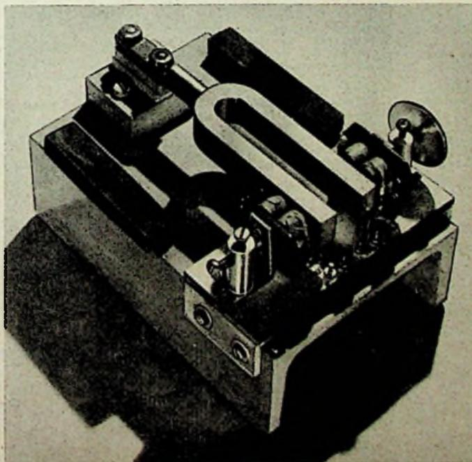
Bild 2. Ansicht eines 1000-Hz-Stimmgabelfrequenznormals. Zu beiden Seiten der Stimmgabel steht man die einstellbaren Erregerspulen, aus je zwei Kopfhörersystemen bestehend. (Aufnahme: Carl Stumpf)
