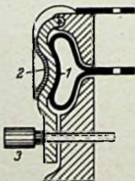
Schaltung zur Demodulation von frequenzmodulierten Schwingungen. Deutsche Patentschrift 806 792. Telefunken, Berlin. 30. 8. 1949.
