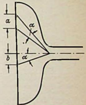
Bild 105. Zur Veranschaulichung des Tangensfehlers
