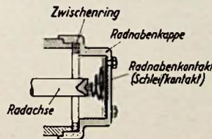
Bild 10. Reifenentstörung durch Radnabenkontakte
