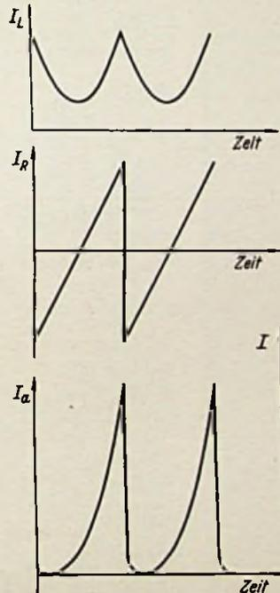
geradliniger wird die Kurvenform des Anodenstromes. Sind Frequenz, Transformator- und Spulendaten gegeben, so kann man genau bestimmen, wie die Anodenstromkurve aussehen muß, damit durch die Ablenkspulen ein sägezahnförmiger Strom fließt.
