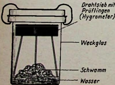
Bild 1. Weckglas als Feuchtraum zur Kondensatorprüfung
