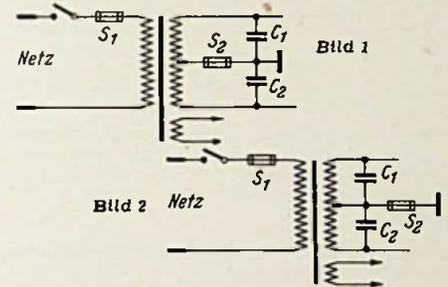
den kurzgeschlossenen Kondensator  $C_1$  die doppelte Spannung als ursprünglich vorgesehen an  $C_2$ . Er wird in kurzer Zeit ebenfalls durchschlagen und damit die gesamte Anodenwicklung kurzschließen. Die Schutzmaßnahme wirkt sich also gerade gegenteilig aus und führt zur Beschädigung eines weiteren Einzelteiles. Die Primärwicklung ist nun meist im Vertrauen auf die Sekundärsicherung zu hoch bemessen und spricht erst an, wenn der Netztransformator durchgebrannt ist.
