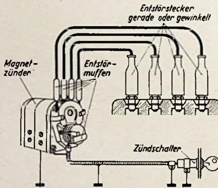
Bild 5. Behelfsmäßige Entstörung einer Magnet-Zündanlage
