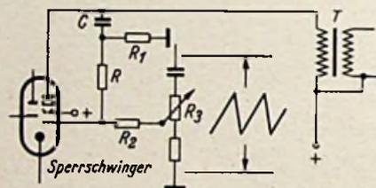
Bild 109. Frequenzabhängige Gegenkopplung nach Philips
