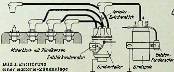
Bild 1. Entstörung einer Batterie-Zündanlage
