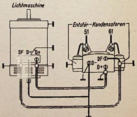
Bild 7. Entstörung einer Lichtmaschine mit getrenntem Regler
