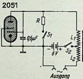
Einfache batteriegespeiste Thyatronschaltung zur Erzeugung hoher Wechselspannungen
