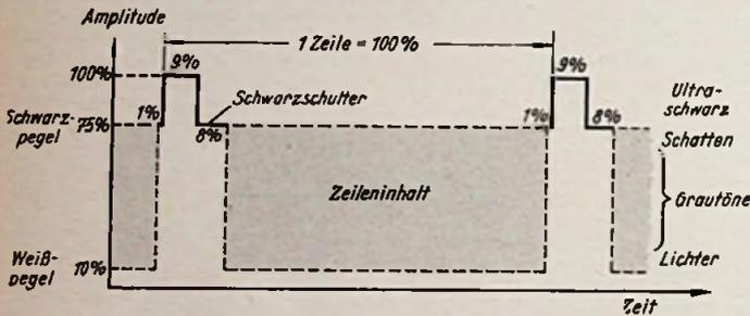
**Bild 6. Deutsche Fernschnorm für Bildinhalt und Gleichlaufzeichen einer Zeile**
