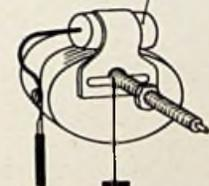
Bild 9. Entstörung eines Scheibenwischers
