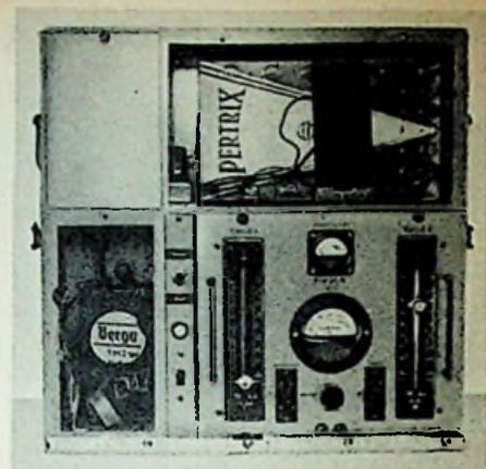
Bild 4. Verstärkeranlage F - V 34 K, Batterie- und Zubehörfach geöffnet
