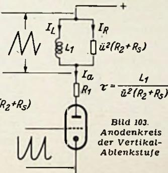
Bild 103. Anodenkreis der Vertikalablenkstufe
