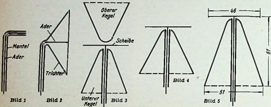
Bild 1. Rechtwinklig abgebrogenes Koaxialkabel. — Bild 2. Kabelmantel zum Trichter erweitert. — Bild 3. Trichter und Kabelader rotierend gedacht, ergeben eine Scheibe mit zwei Kegeln (schematisch im Schnitt dargestellt). — Bild 4. Durch Weglassen des oberen Kegels entsteht die Discone-Rundstrahl-Antenne. — Bild 5. Abmessungen einer Discone-Antenne für UKW-Rundfunk und Fernsehen (Maße in Zentimetern)
