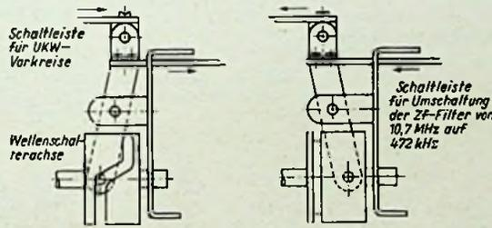
Bild 2. Steuerung der zusätzlichen UKW-FM-Schaltkontakte durch eine Schwenkscheibe auf der Wellenschalterachse
