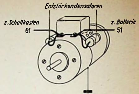
Bild 6. Entstörung einer Lichtmaschine mit angebautem Regler
